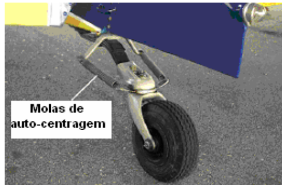
Figura 123 – Roda de cauda com molas de auto-centragem
