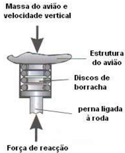
Figura 115 – Amortecedor de discos de borracha
