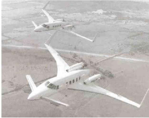
Figura 25 – Fuselagem integralmente construída com materiais compósitos
