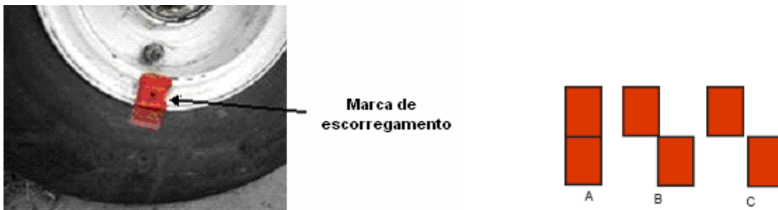
Figura 147 – Marcas de escorregamento
