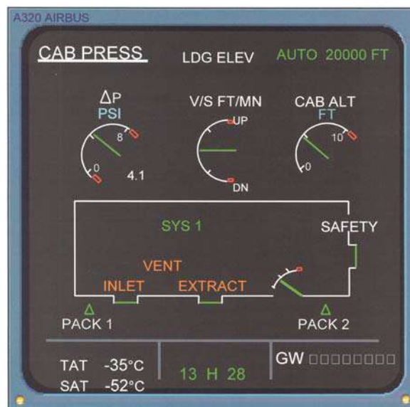
Figura 251 – Sistema digital de indicação da pressurização
