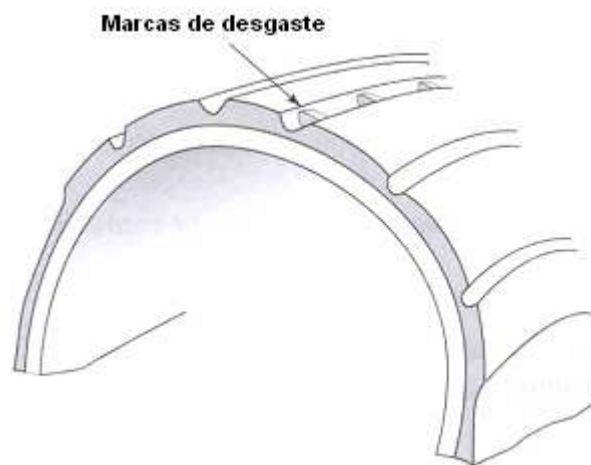
Figura 149 – Marcas de desgaste do pneu
