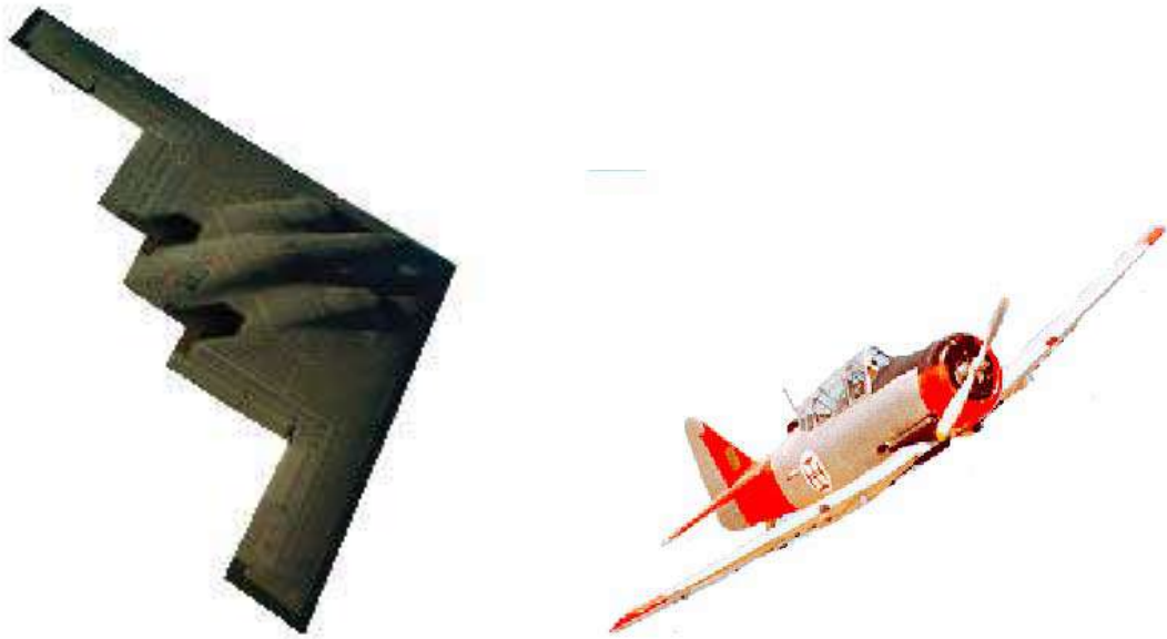
Figura 31 – Aeronave não fuselada (esquerda) e aeronave monofuselada (direita)
