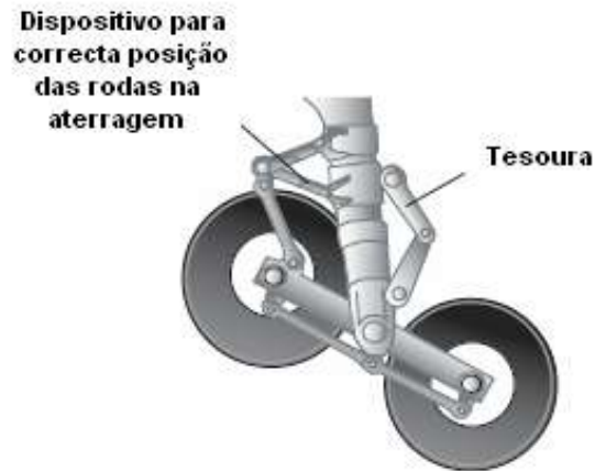
Figura 129 – Toque na pista de apenas de um par de rodas durante a aterragem
