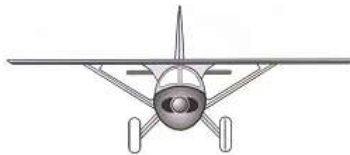
Figura 40 – Fixação da asa tipo semi-cantiliver
