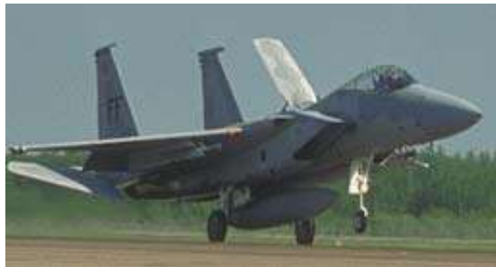
Figura 114 – Speed brak instalado na parte superior da fuselagem
