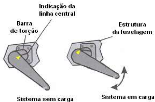
Figura 117 – Amortecedor de barra de torção
